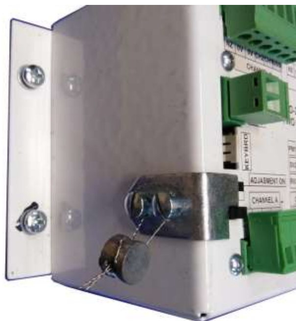
Рисунок Е.3 - Пломбировка отсчетного устройства ЭКО
